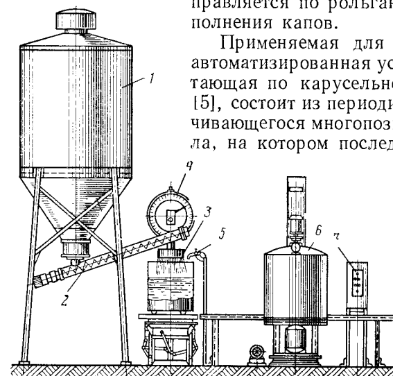
Рис. XV.2. Схема механизированной установки для приготовления и вакуумирования гипсового теста
